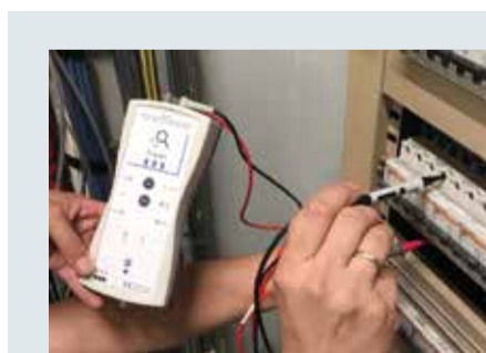
Afbeelding 1. Bij de meting wordt de impedantie van de installatieautomaat als shunt gebruikt.
